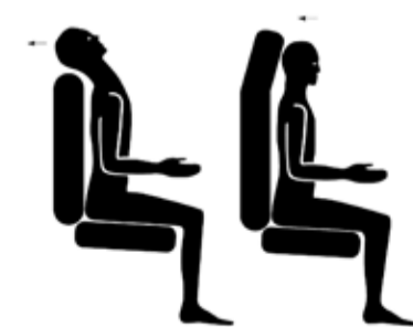
Gambar 1. (Kiri) Posisi headrest rendah yang tidak menopang kepala sehingga terhempas ke belakang serta mengakibatkan cedera akibat hiperekstensi leher dan cedera otak akibat perlambatan. (kanan). Posisi headrest tinggi sehingga mengurangi pergerakan kepala dan menjaga kepala pada posisi sejajar dengan tubuh bagian atas. 1
